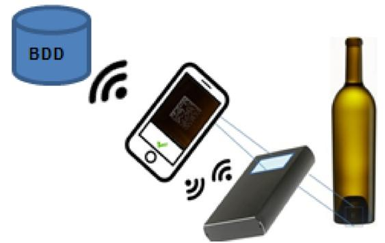
L'objectif du projet est de développer un prototype comprenant la partie électronique du système connecté, la partie logicielle du système connecté ainsi qu'une application Android qui pilote le système embarqué et identifie la bouteille.
