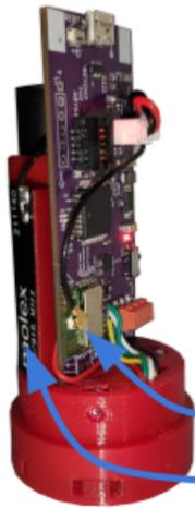
Nous utilisons une modulation en GFSK, centrée en 869.5MHz avec une déviation de 25 KHz pour réaliser une communication mono-directionnelle, complétée d'une vérification par checksum.
