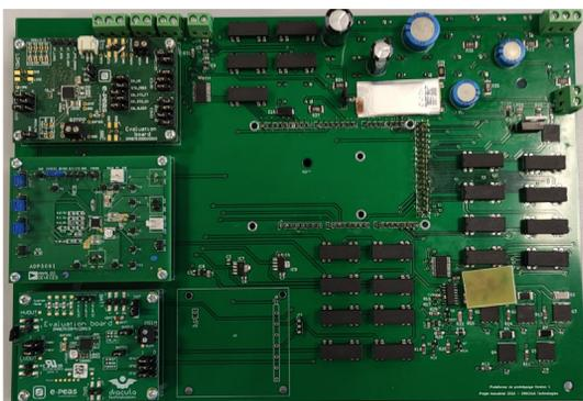
La plateforme de prototypage permet de **simuler l'usage client** et de **dimensionner les modules LAYER®**. Les données mesurées par la plateforme sont communiquées au **logiciel développé sur Windows**.
