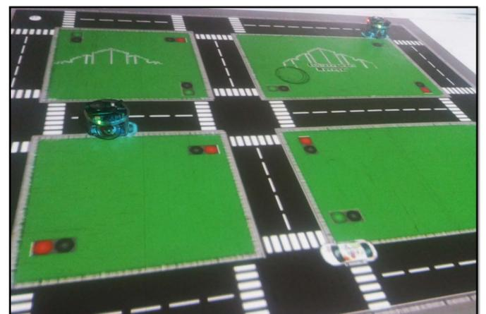
Projection au sol de la ville virtuelle simulée par MASH avec les robots E-puck.
