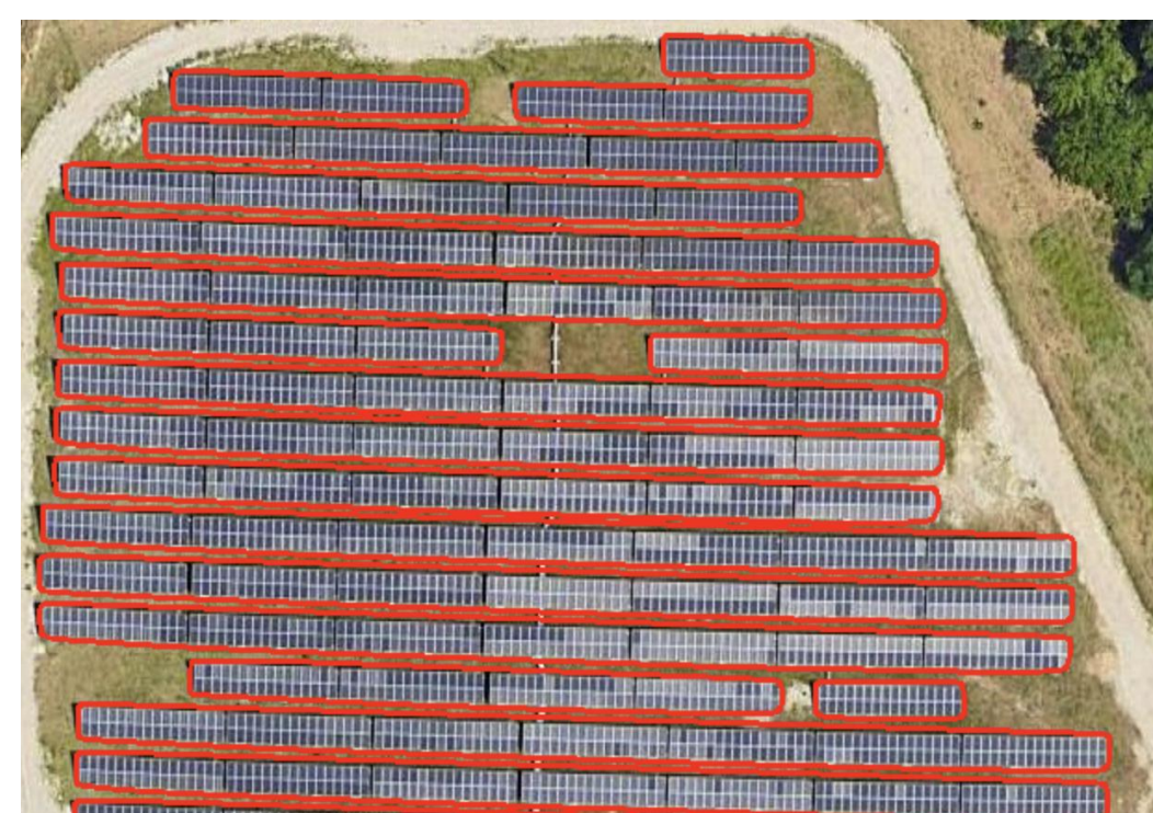
Exemple de résultat obtenu par l'analyse d'image, le rouge représente les groupes de panneaux trouvés
