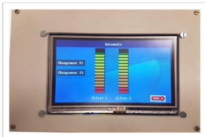
La **carte électronique** est fonctionnelle et répond aux besoins du client. Les capteurs détectent bien les problèmes de colmatage, de fuite et d'usure. Les données sont sauvegardées périodiquement sur la carte micro SD ,
