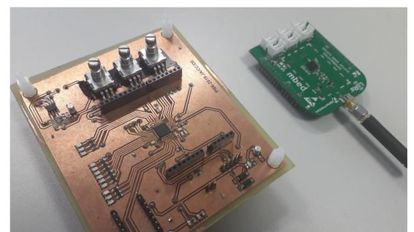
Les **antennes hélicoïdales** ont été sélectionnées pour permettre les communications : leur prix plutôt bas et leur bonne qualité de transmission sont certains de leurs avantages. Une **carte banc de tests** a été réalisée et permet de vérifier le bon fonctionnement des communications radios, du protocole et du système Liebearth.
