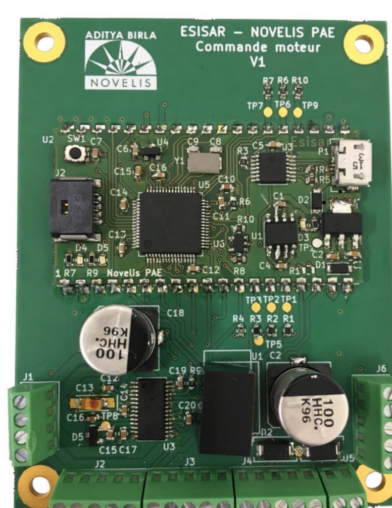
Carte électronique réalisant l'asservissement du moteur
