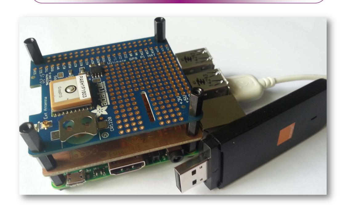
Le prototype de **SensOrLab v2** est réalisé. Il s'agit alors d'une mallette robuste comportant des éléments grands publics tels qu'une carte Raspberry Pi2, une clé 4G et un module GPS ainsi que le logiciel.
