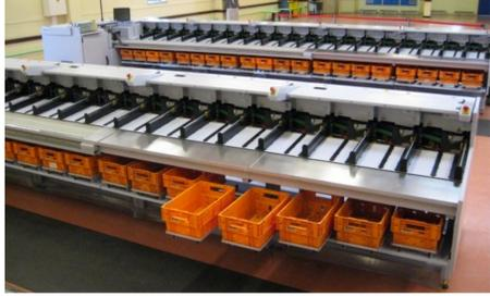
**L**es machines de tri sont conçues et fabriquées sur mesure en fonction de la demande et des exigences du service à équiper. Elles sont composées de plusieurs entités, assurant la supervision, toute la partie algorithmique de tri et les automates. La taille des machines varie en fonction des modèles, et peut atteindre plusieurs centaines de mètres.
